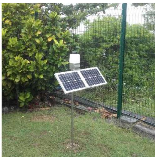
FIGURE 4 – Capteur autonome Cairpol de  $H_2S$  de Madininair - Source : Madininair
