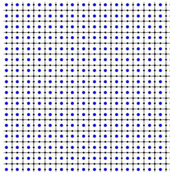
FIGURE 7 – Points retenus sur maillage initial (Point bleu : retenu, point noir : supprimé)
